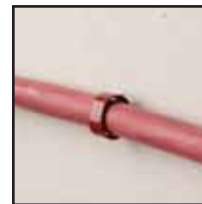
La force moyenne nécessaire à l'extraction du collier est de 107 N.
