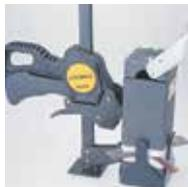
**Étape 4** Fermez le couvercle et déclenchez la réaction avec le pistolet allumeur. Ouvrez le moule après 10 secondes
