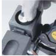
**Étape 2** Fermez le moule et mettez le disque métallique en place
