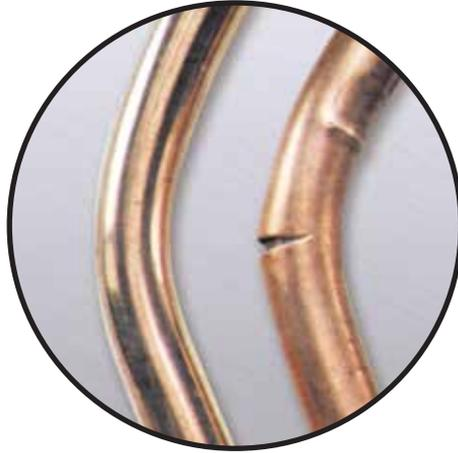
La photo ci-dessus montre deux piquets de terre soumis au même essai de charge de pression. Le piquet de terre avec revêtement de cuivre ERICO, montré sur la gauche, se tord sans se déchirer, se craquer. Le piquet avec chemisage en cuivre montré sur la droite a développé des fissures et des déformations de la gaine extérieure, qui vont réduire significativement la durée d'utilisation et menacer l'intégrité de l'électrode.
