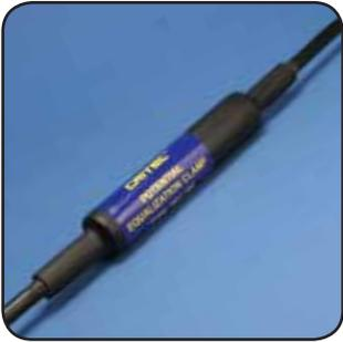
Le PEC (Potential Equalization Clamp, Eclateur) se comporte généralement comme un circuit ouvert. Cependant, une fois que la différence de potentiel de la mise à la terre dépasse la tension disruptive de la PEC (dans des conditions transitoires), le circuit se ferme immédiatement et les potentiels de mise à la terre sont égalisés, protégeant ainsi l'équipement et les personnes.
