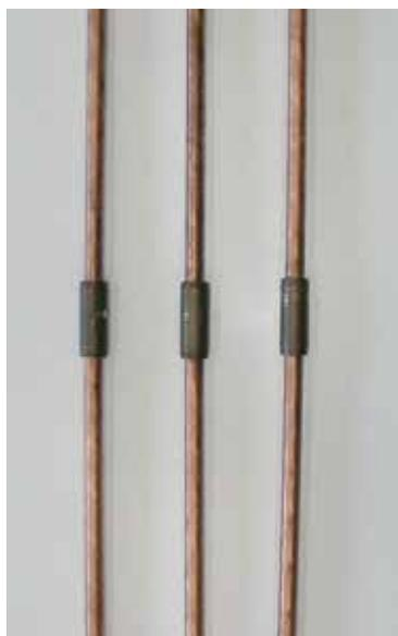
**Échantillons après les tests de brouillard salin**
