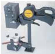
**Étape 1** Empiler les joints et les conducteurs à souder dans le moule sec
